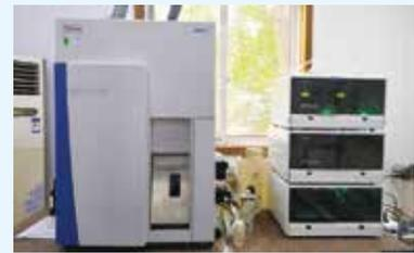
图14, 可与各个品牌的ICPMS组成IC-ICPMS联机
