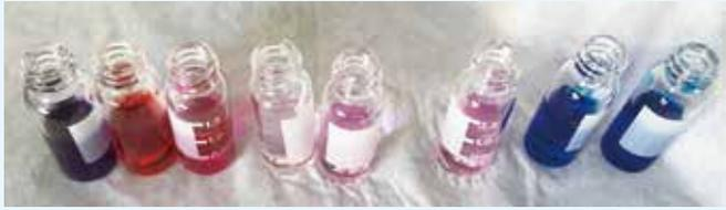
图12, 各种深色样品, 不需脱色, 直接上机测试。
